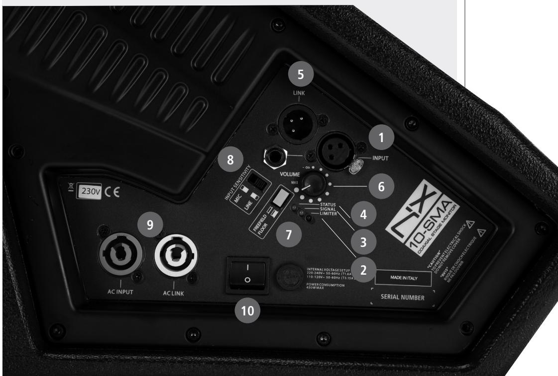
**1** EINGÄNGE STEREOKLINKEN- / XLR-BUCHSE, WEIBLICH (SYMM./UNSYMM.). Zum Anschluss von Klinken- oder XLR-Steckern. Die symmetrischen Eingänge können verwendet werden, um symmetrische oder unsymmetrische Mikrofonsignale oder Audioquellen mit Linepegel anzuschließen.
