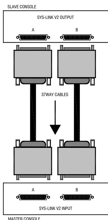
**Опция входов/выходов Sys-Link V2** В стандартной комплектации на месте для опции установлена заглушка. На ее место можно установить опциональные карты, которые обеспечивают входы, выходы и систему PFL пульта через пару 37way D коннекторов для подключения к другим пультам Allen & Heath с опцией Sys-Link V2. При этом **GL2800** становится модулем расширения входных каналов (ведомое устройство) или может увеличить число своих входных каналов (ведущее устройство) при подключении к другим пультам.
