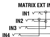
Матрицу можно использовать при добавлении источников окружения записи и персонального мониторинга, при добавлении прямого выхода или аух-микса для быстрого создания мониторного сигнала из главного микса и выбранного канала (каналов), при подключении еще одного пульта для запитывания той же АС.
