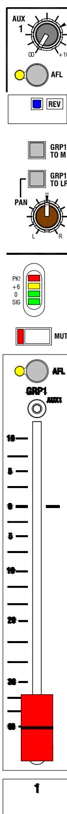
**МАСТЕР-РЕГУЛЯТОРЫ AUX 1-8** Каждый аух-микс имеет мастер-регулятор уровня для подстройки выходного уровня для согласования с внешним оборудованием, для управления мониторными посылами и посылами на эффекты без влияния на баланс в миксе. Обеспечивается усиление до +10dB выше номинального значения 0dB. Заметьте, что в мониторном режиме мастер-регулятор становится мастер-регулятором группы.
