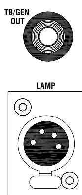
**ГНЕЗДО ДЛЯ ЛАМПЫ LAMP** Пульт имеет два 4-х штырьковых XLR гнезда для подключения стандартной 12-ти вольтовой лампы на гусиной шее для освещения рабочего пространства во время работы в темных местах. Мы рекомендуем лампу Allen & Heath LEDlamp с холодным белым светом.
