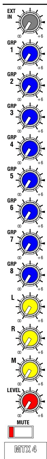
Матрица раскрывает огромные потенциальные возможности пульта **GL2800**. Она обеспечивает 4 дополнительных выхода. Это своего рода "микшер внутри микшера", на выходе которого получается микс из любой комбинации групп, главного LR микса и внешних входов. Она может быть использована для дублирования главных выходов и создания или создания новых миксов из этих выходов. Органы управления матрицы удобно расположены в стороне от основных органов управления, чтобы избежать случайного вмешательства.
